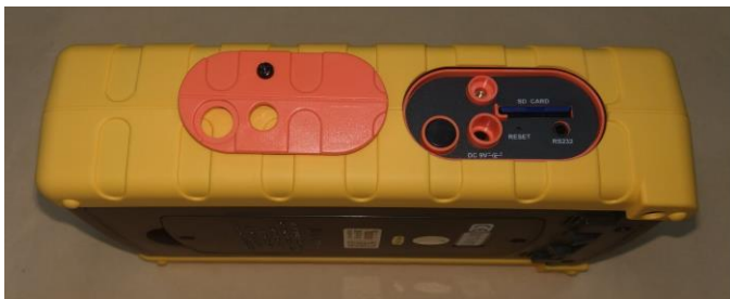
DW-6095 拆保護蓋，SD 卡裝在 SD 卡匣中
