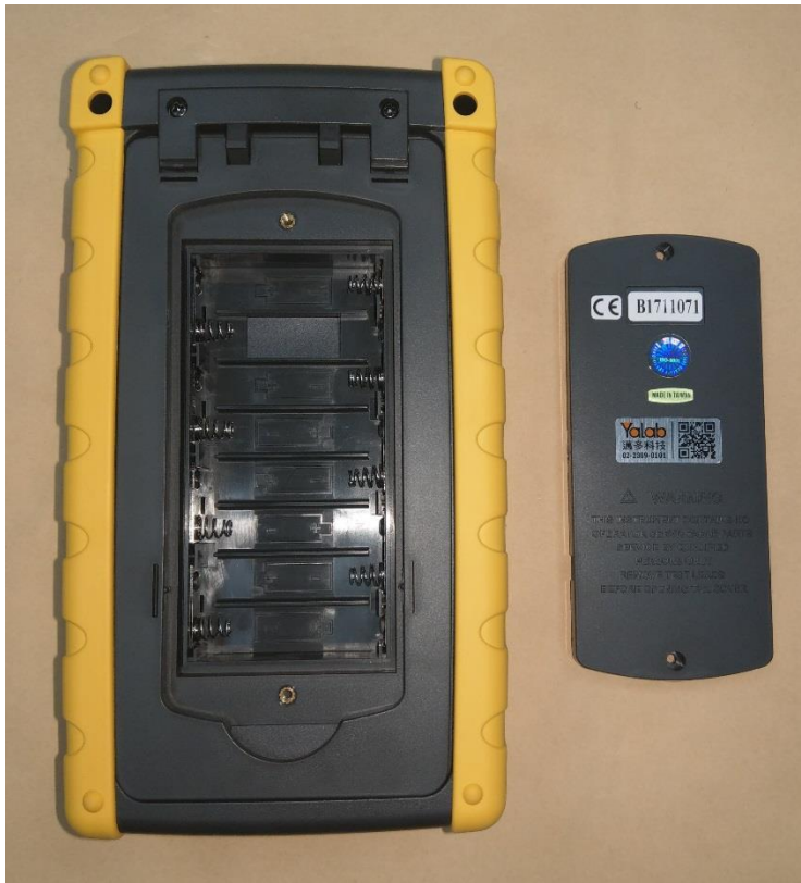
DW-6095 拆下電池盒蓋，可以裝 3 號電池 8 顆
