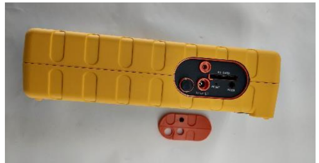
RS232/USB 介面+SD 紀錄卡槽+外接電源孔
