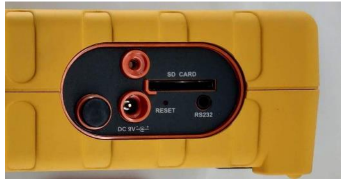
RS232/USB 介面+SD 紀錄卡槽+外接電源孔
