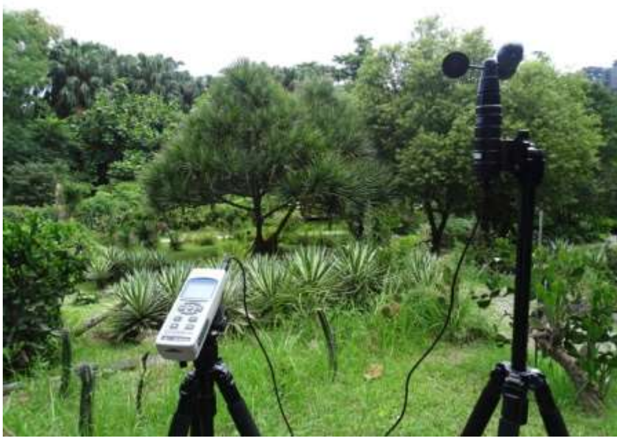
AM-4257SD 杯式風速紀錄器 野外安裝實景
